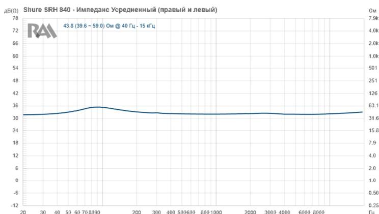
Рис.1. Измеренное сопротивление наушников Shure SRH840 в диапазоне слышимых частот.
