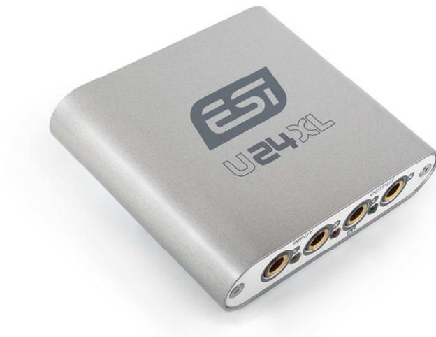
Для начала проведу измерение параметров с помощью **RMAA**, подавая выход сигнала (ЦАП) на вход (АЦП) самой же карты. Поскольку у карты только одна частота 48 кГц, то использую её в тестовом сигнале, битность в системе выставил 24 бит- максимальную. В таблице показаны результаты измерения без нагрузки (XX) на выходе ЦАП, сигнал снимал с выхода наушников. Измерения проводил в системе Windows 11 x64 бит.
