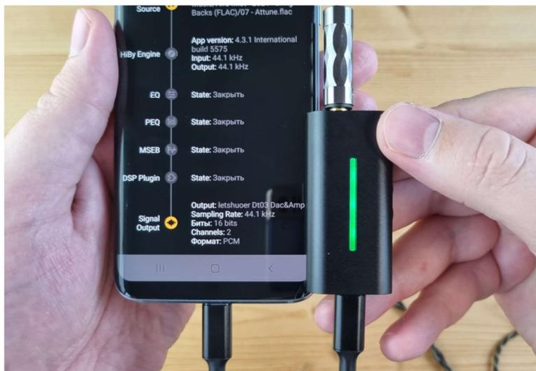
Все измерения буду проводить для небалансного выхода на наушники 3,5 мм. Как источник использовался телефон **POCO M3** (Андроид 12), плеер **Eddict Player** в режиме побитового вывода данных, чтобы данные попадали на ЦАП без передискретизации.
