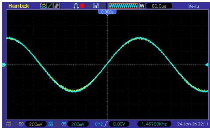
Где мы видим пик синуса по уровню около 400 мВ, действующее значение получаем делением пикового значения на 1,41, получаем 283 мВ. Находим мощность по формуле:
