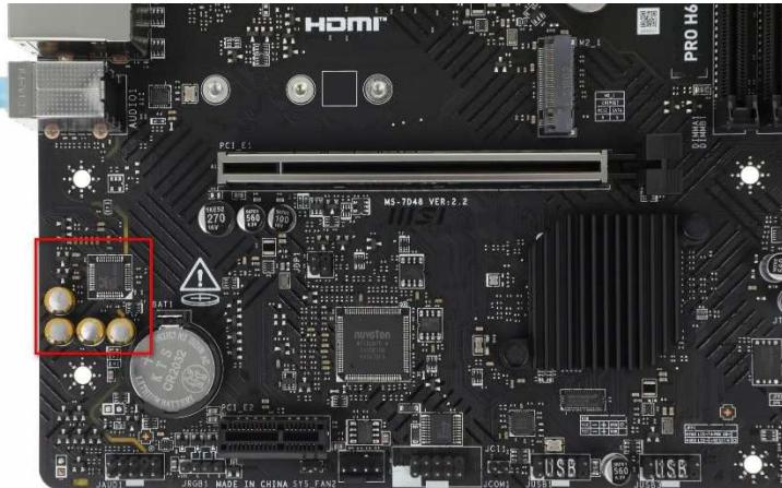
Искажения под нагрузкой 28 Ом на выходе наушников тоже растут значительно с 0,0042 до 0,010%. Возможно, рост искажения связан не с нагрузкой сам по себе, а с тем, что была увеличена громкость с 32 делений до 70 под нагрузкой. При этом, на холостом ходу искажения минимальны на линейном выходе (сзади системного блока) и равны 0,0025%, что логично, так как нет на выходе дополнительного усилителя, который стоит на выходе наушников (на передней панели).
