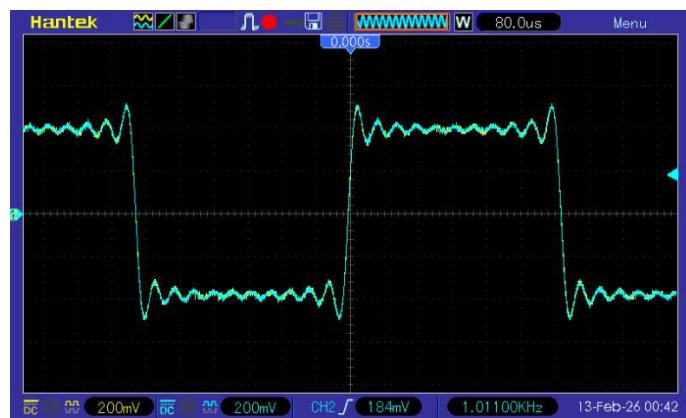
Как видим на графиках, напряжение в пике на синусе достигает всего 400 мВ! В максимуме имеем на синусе около 3В, т.е. ЦАП работает на 1/7,5 от всего диапазона. А итоге мощность на 28 Ом получается всего 2,9 мВт, ну максимум в два раза больше, при прослушивании, т.е. порядка 6 мВт! При этом видим, что у Keyston используется не стандартный цифровой фильтр по умолчанию, который имеет выбросы после фронта, у Shanling используется классический фильтр по умолчанию.
